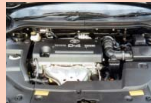
1AZ-FSE型2000ccDOHCエンジンは最高出力155馬力。
