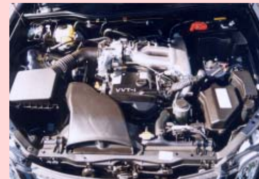
4WDのエンジンは2500ccEFIツインカム24でノンターボのみ。最高出力は196馬力。
