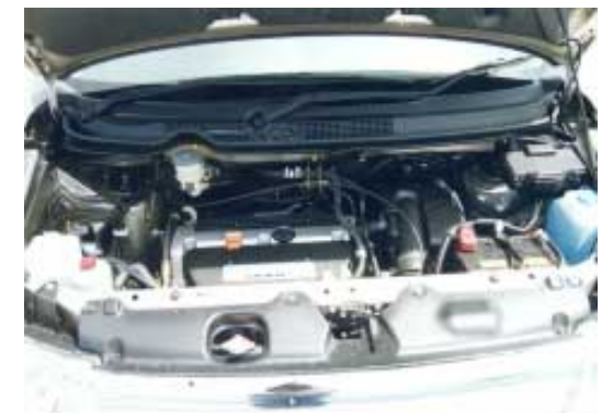
K20A型水冷4気筒DOHCエンジンは2000ccで最高出力160馬力を発揮。
