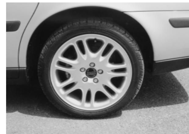
225/45R17タイヤに7.5J x 17のアルミホイールを装着する「T-50」。
