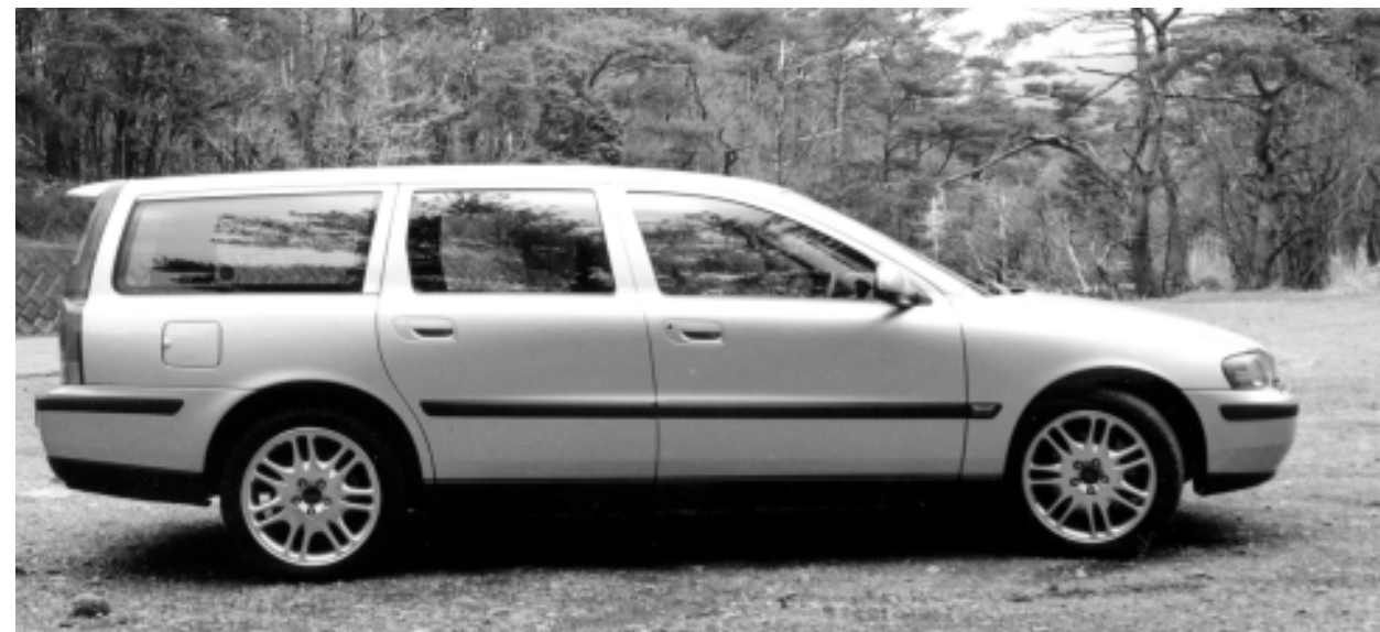
全長4710mmのボディに2755mmのロングホイールベースが特徴。
